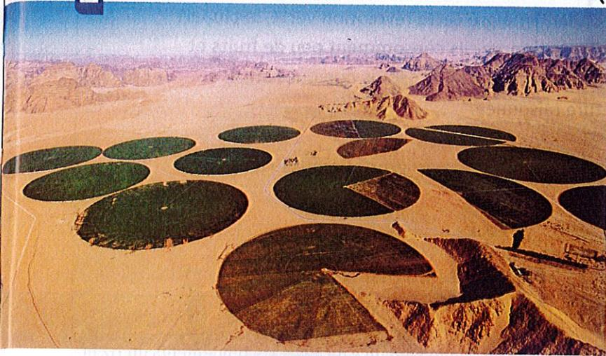
Ces champs circulaires d'un kilomètre de diamètre sont arrosés par des rampes tournantes qui puisent l'eau dans une nappe souterraine. La Jordanie a pu conquérir ainsi de nouvelles terres agricoles.
